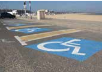
រូបភាព ២.៣.៥. គំរូអំពីទីធ្លាសមស្របសម្រាប់ ការចតយានយន្តជនមានពិការភាពនីមួយៗ គួរកត់សម្គាល់ថារូបភាពនេះមិនបានដាក់ស្លាក សញ្ញាអន្តរជាតិសម្គាល់ទីតាំងចំណតនិង ជម្រាលចុះឡើងខ្សែន។
