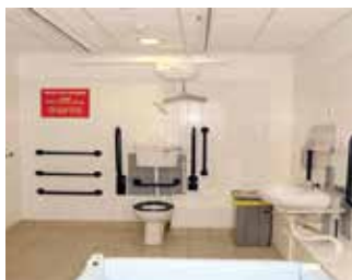
រូបភាព ៥.៣.១.២ គំរូអំពីការរៀបចំទីតាំងបង្គន់សម្រាប់ភេទច្រើននៅចំណុចសម្រាប់អ្នកប្រើប្រាស់ត្រូវការជំនួយ
